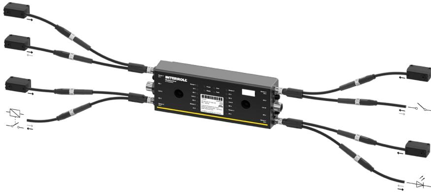
MultiControl能控制输送机的四个区段，还能控制四个RollerDrive和四个传感器。甚至是复杂的输送机模块（例如：移栽机或高性能转向装置）都能由MultiControl控制。借助y形电缆，还能连接四个可独立配置的附加I/O。
