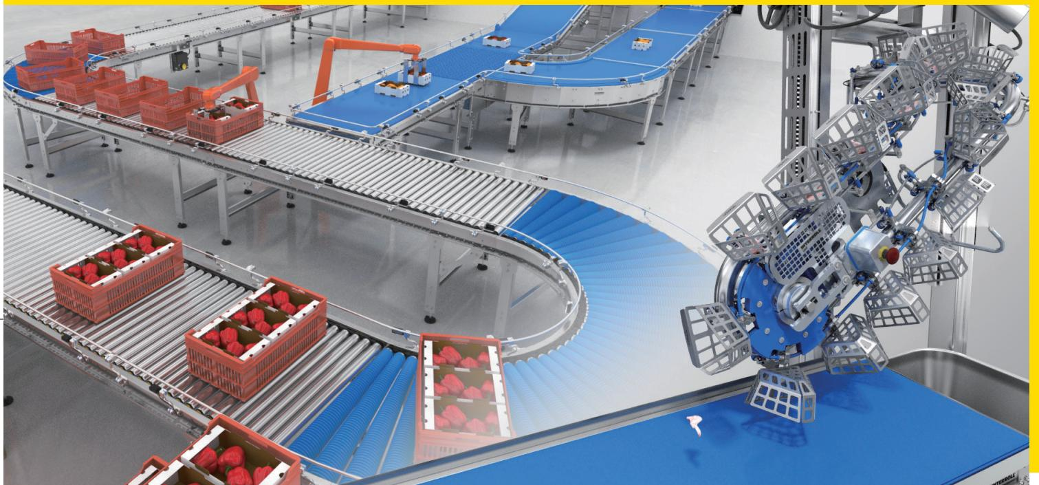
“英特诺的超级卫生转载机显著减少了转移到下一个输送机系统的残留物。”
